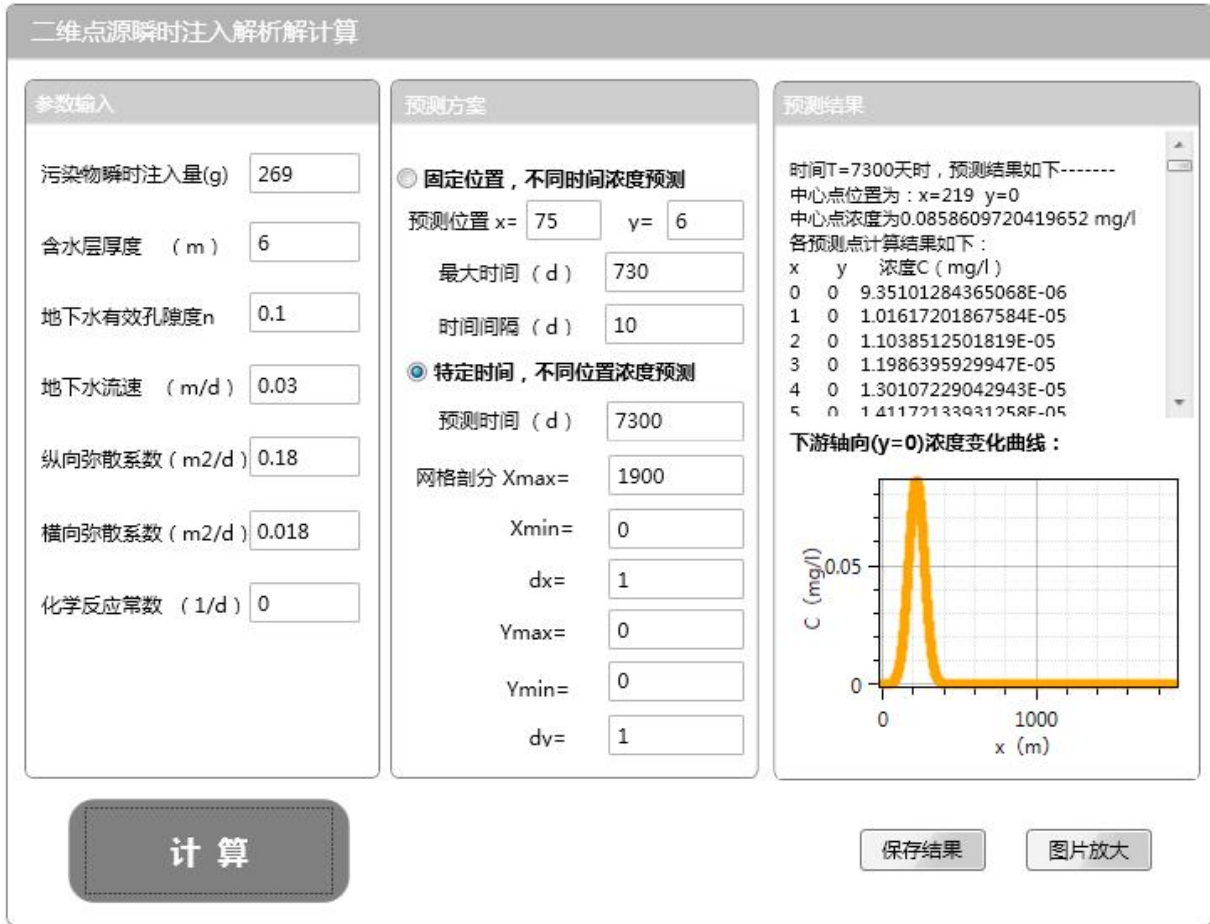
图 6-7 非正常工况下 7300d 项目下游 NH 3 -N 浓度变化情况
