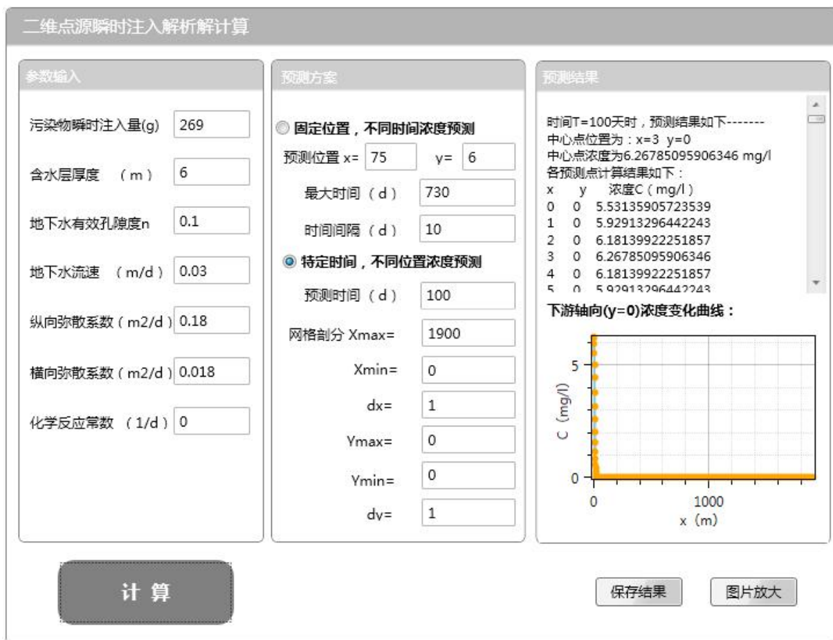
图 6-5 非正常工况下 100d 项目下游 NH 3 -N 浓度变化情况
