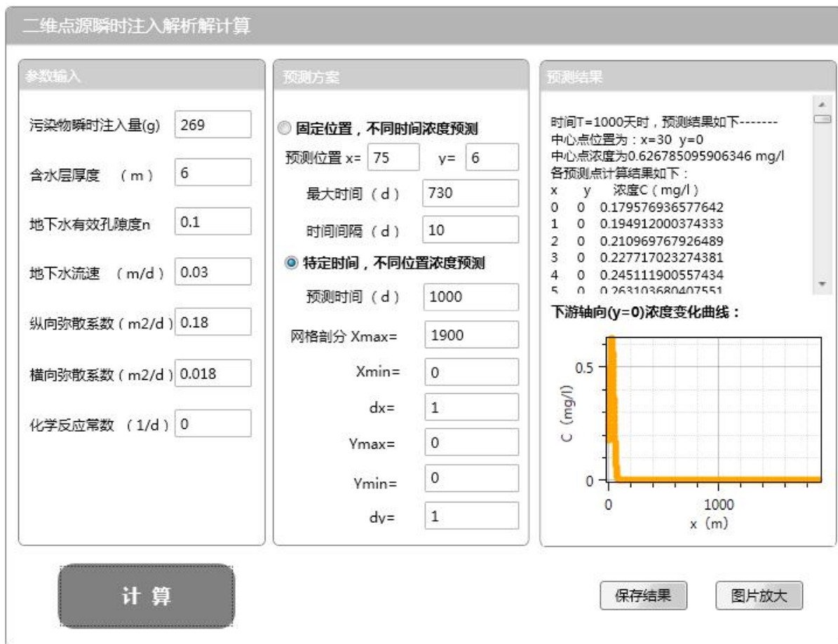
图 6-6 非正常工况下 1000d 项目下游 NH 3 -N 浓度变化情况
